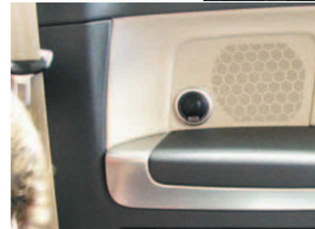
Hintergründig: Korrektur eingepegelte Hecklautsprecher lindern die Seitenlastigkeit des Frontsystems enorm.
