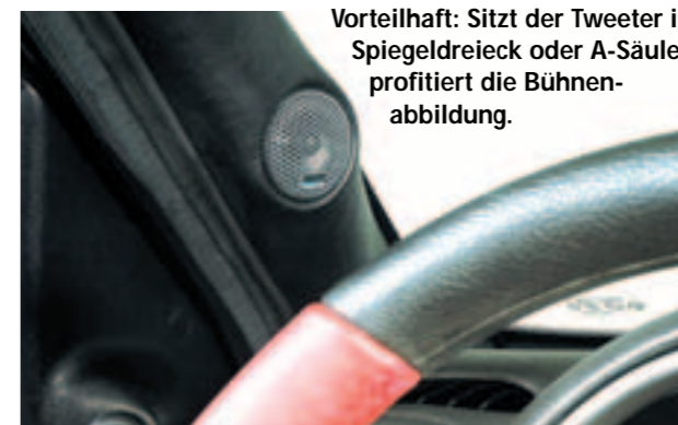
Ungeschickt: Ein weit hinten verbauter Tweeter wie hier im Opel Vectra verschlechtert das Frontstaging.
