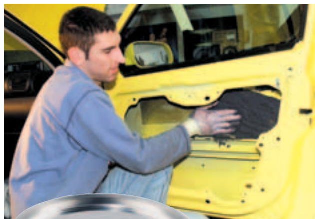
Ruhe bitte: Gründliches Dämmen von Türblech und Verkleidung lässt das Klangbild druckvoller und impulsfreudiger werden.
